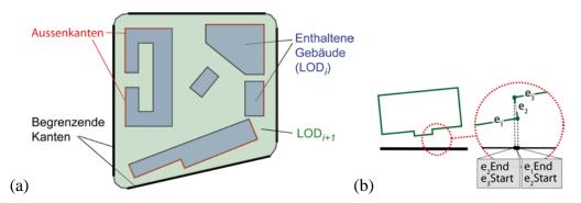
Abb. 4: Zuordnung von Flächen der LOD<sub>r</sub>-Gebäude zu Flächen der LOD<sub>i+1</sub>-Geometrie ist nur teilweise sinnvoll (a). Auch konkave Bereiche führen durch überlappende Kanten zu Zuordnungsproblemen (b).
