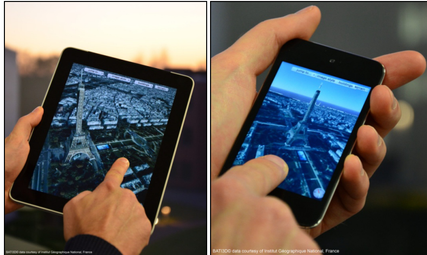
Abb. 3: Die interaktive Clientanwendung auf iPad und iPod touch ermöglicht dem Benutzer ein flüssiges Interagieren mit der leichtgewichtigen Rekonstruktion eines virtuellen 3D-Stadtmodells. Im Bild dargestellt ist das Pariser 3D-Stadtmodell (BATI3D©-Daten sind Eigentum des Institut Géographique National, France.)
