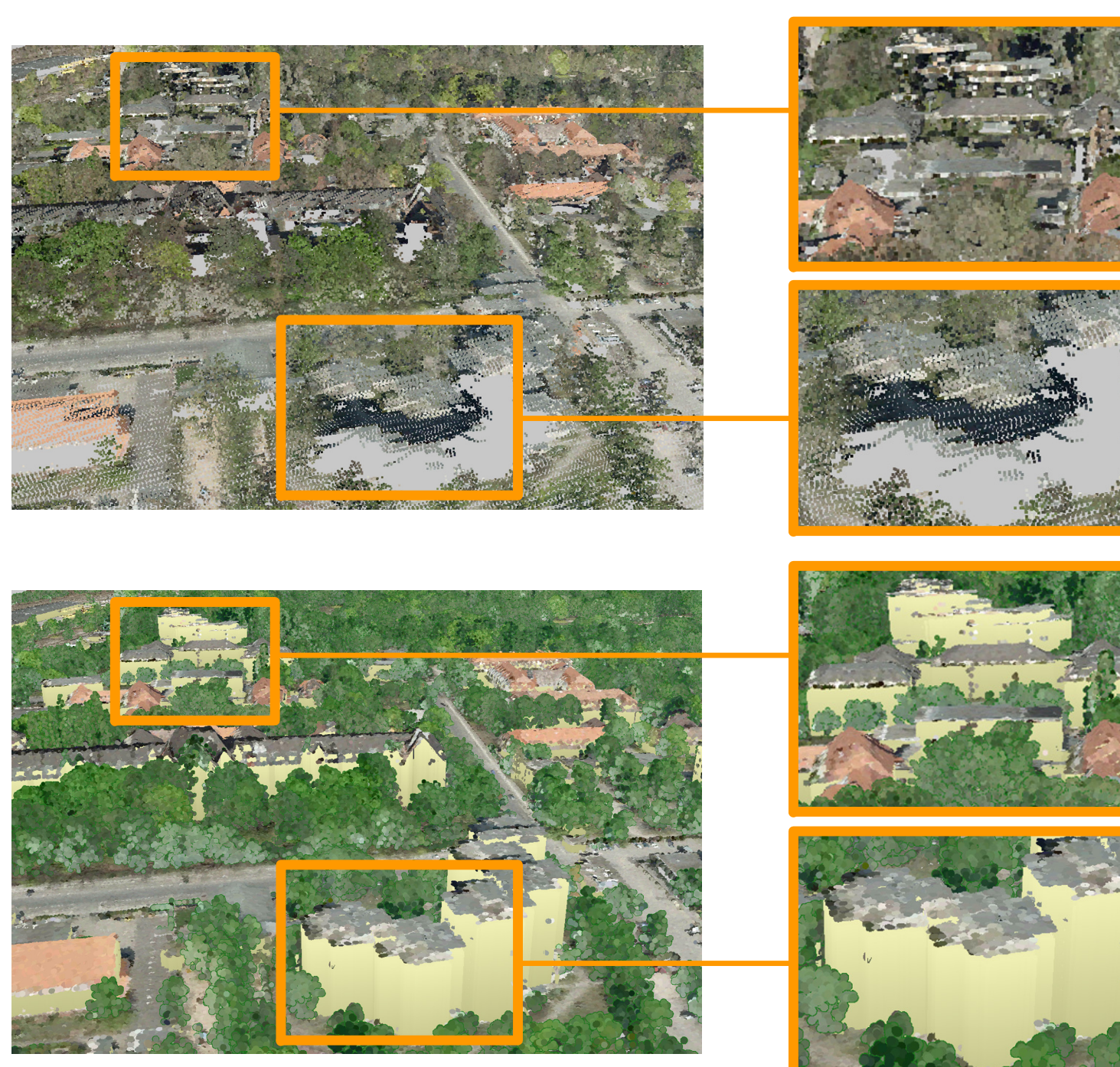
Abb. 2: Rendering einer 3D-Punktwolke mit einheitlichen Darstellungsstil (oben) und unter Berücksichtigung semantischer und topologischer Attribute (unten).
