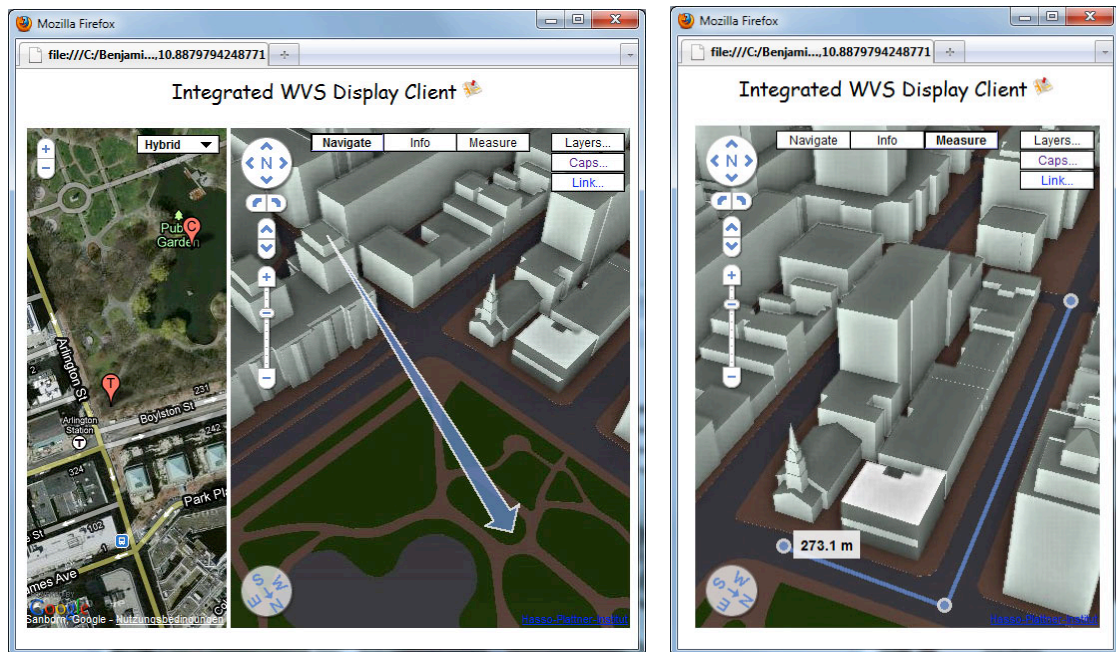
Beispiel von Prototypen webbasierter Clients, die serverseitig gerenderte komplexe 3D-Modelle im Web Browser visualisieren und ausgewählte Fachfunktionalität bereitstellen.
