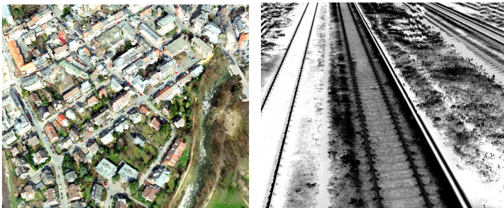
Abbildung 2: Beispiele für 3D-Punktwolken einer Befliegung (links) und einer terrestrischen Erfassung (rechts).
