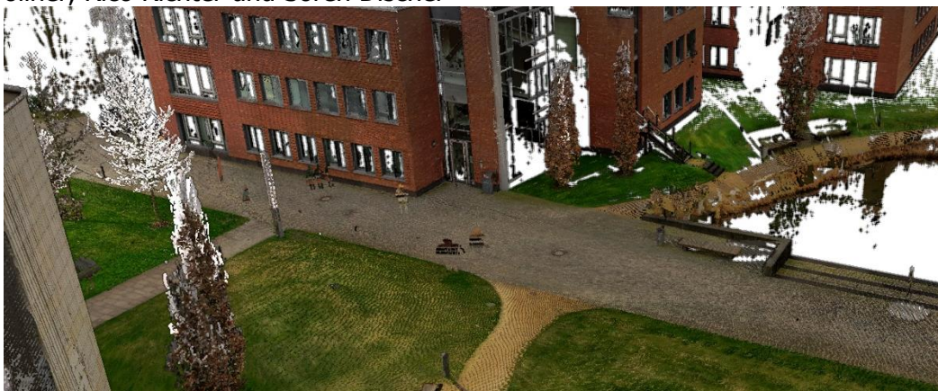
Abbildung: 3D-Scan des HPI-Campus erstellt mit einer Kamera und einem terrestrischen Laserscanner.
