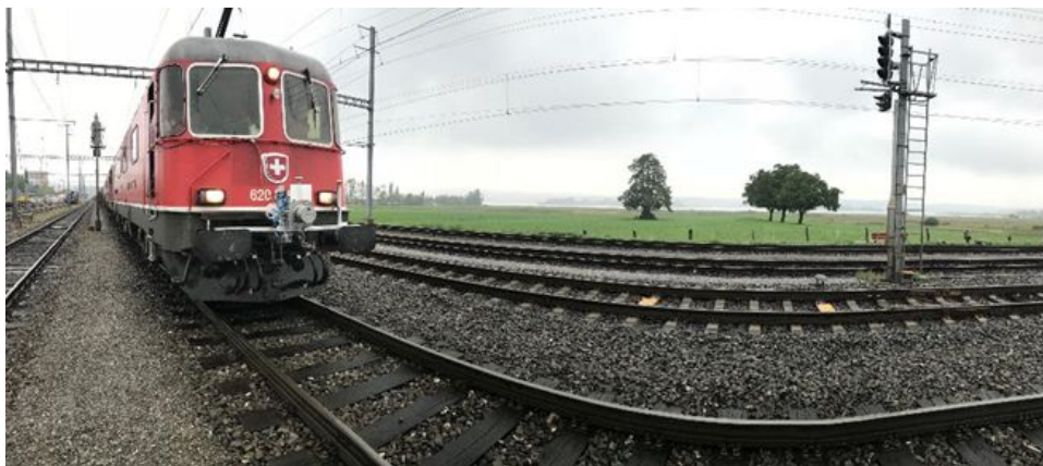
Abbildung 1: Zug mit frontal montiertem 3D-Erfassungssystem. Typische Infrastrukturelemente wie Signale, Balisen (gelb) und Oberleitungsmasten in der Gleisumgebung.
