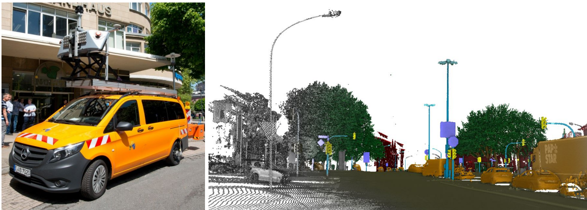
Abb. 1: 3D-Erfassungsfahrzeug (links); visualisierte unklassifizierte und klassifizierte Rohdaten (rechts).
