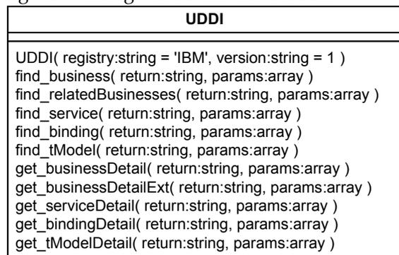
**Abbildung 31: Klassendiagramm der UDDI-Klasse aus dem PEAR-Paket**
