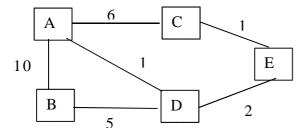
Berechnen und erstellen Sie schrittweise die Routingtabelle für Knoten A (inkl. kurzer Erklärung der Vorgehensweise)
